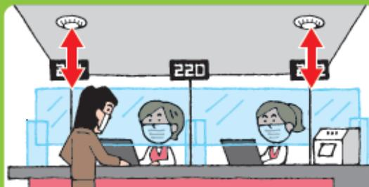
**火災感知器やスプリンクラーの近くに設置しない。** 正常な動作の妨げになります。
