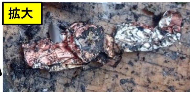
※加圧によって絶縁膜が破損し短絡（ショート）が原因で発火したと推測しています。
